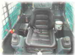
مجهز به سیستم تهویه مطبوع و بخاری کنترل دستگاه و ادوات به وسیله JOYSTICK
