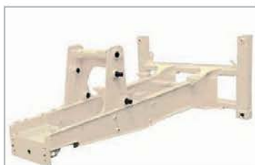
• شاسی با طرح I مناسب برای کارهای سنگین
