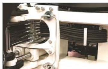
• کشویی یک تکه مناسب برای کارهای سنگین همراه با سیلندرهای هیدرولیک نصب شده در مرکز
